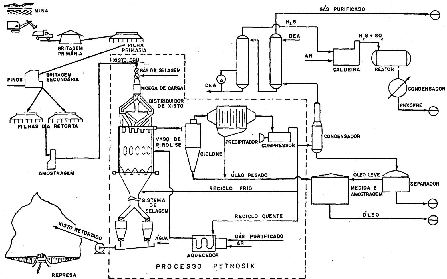
FIG. 4.1 FLUXOGRAMA DE PROCESSAMENTO DE XISTO PELO PROCESSO PETROSIX
