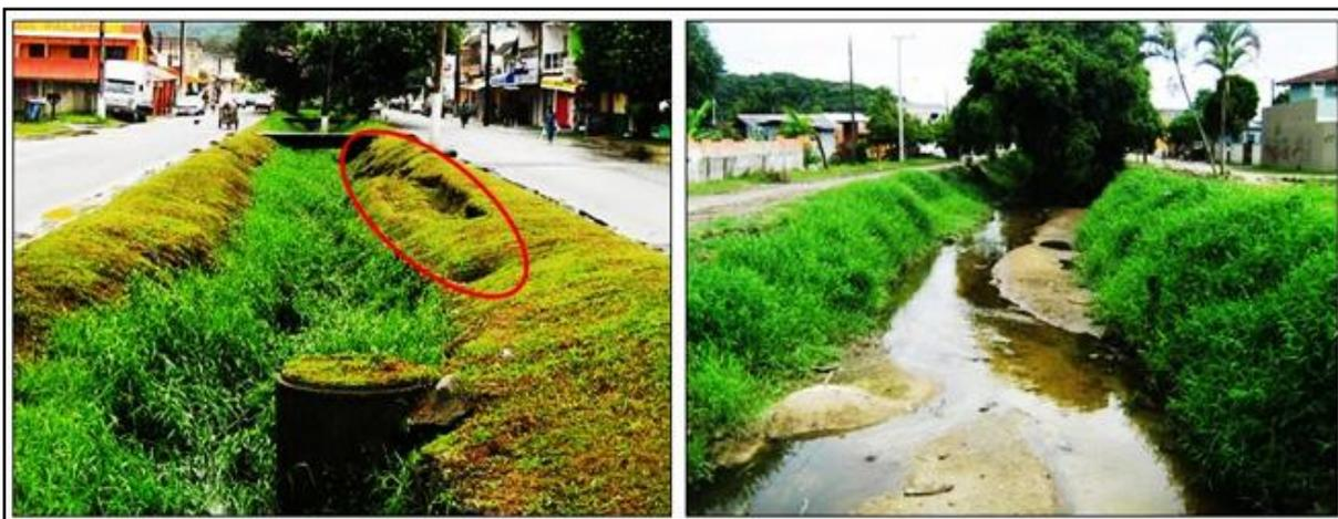
FIGURA 54 – EXEMPLOS DE PROCESSOS EROSIVOS E DE DEPOSIÇÃO SEDIMENTAR (ASSOREAMENTO) – MATINHOS: 2011
